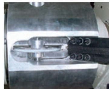
Закрытая трубчатая дуга и входной шкив (диам. 80 мм на VM2x355)
